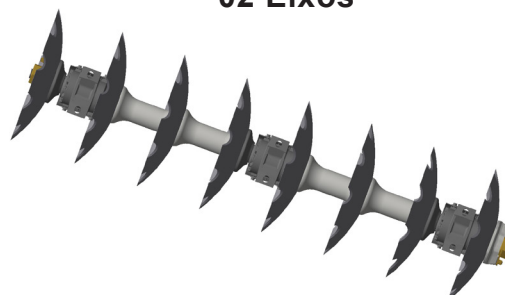
GAPCR / GASPCR 16 Discos 08 Separadores 06 Mancais 02 Eixos
