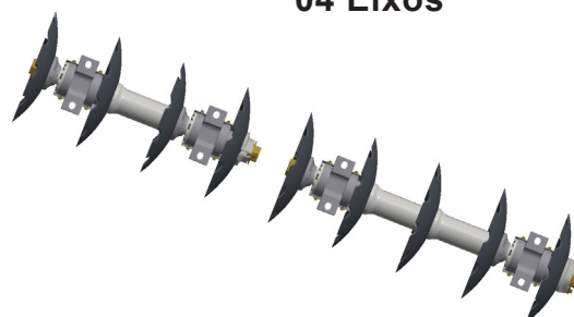
GAPCR / GASPCR 18 Discos 06 Separadores 08 Mancais 04 Eixos
